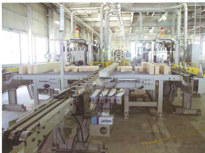
番付け機 (左手前) を過ぎるとツインラインへの分岐点
