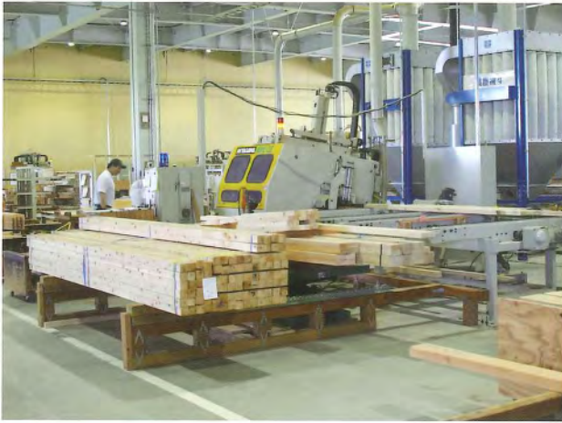
屋根・壁の羽柄材を加工するプレカットマシン
