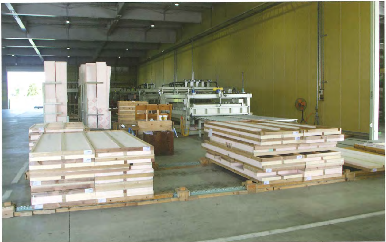
「プレウォール」のパネル組立てライン 年間 650 棟のパネル材を製造している
