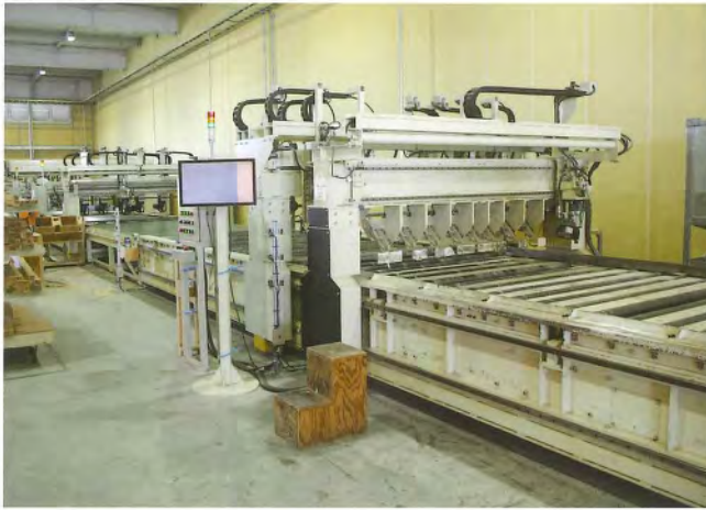
フレーミング、シージング、断熱材の取付けまでを行う
