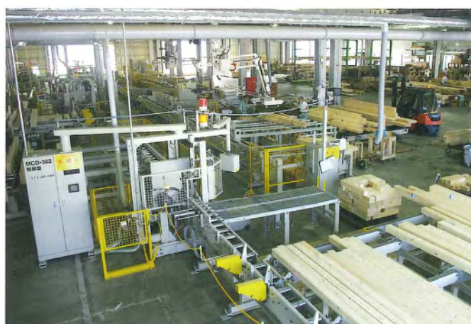
横架材加工ライン (MPS-VX03W : 6.5m仕様)
