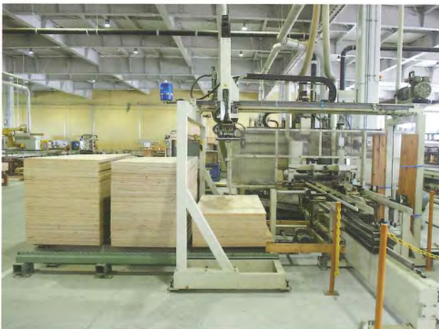
合板を加工するプレカットマシン
