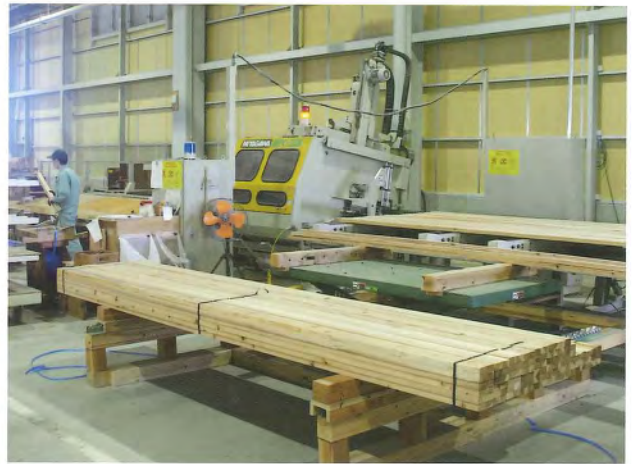
屋根・壁の羽柄材を加工するプレカットマシン
