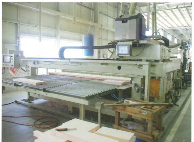
断熱材を加工するプレカットマシン
