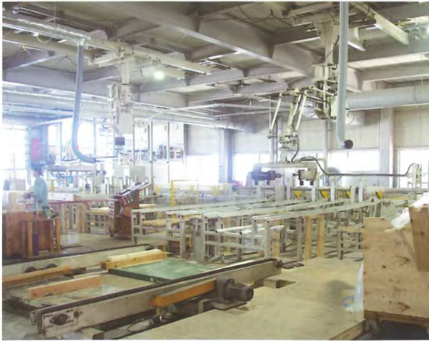
取り出し口に設置された加工板積込装置
